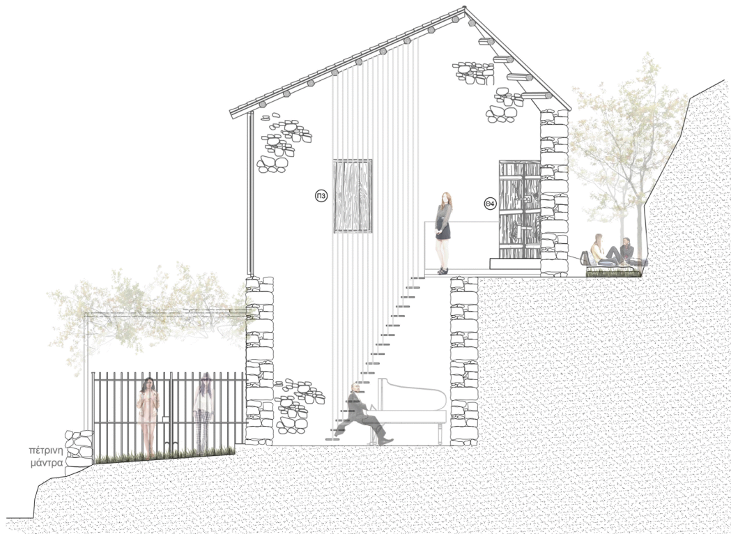
ΤΟΜΗ Β-Β_αποκατάσταση οικοδομής ΚΛΙΜΑΚΑ 1:50
